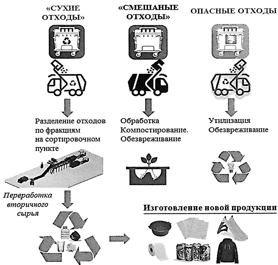
Рисунок 5. Схема движения раздельно накопленных отходов
